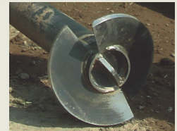
▲反転し、抜いた杭。 拡翼変形はしていない。
